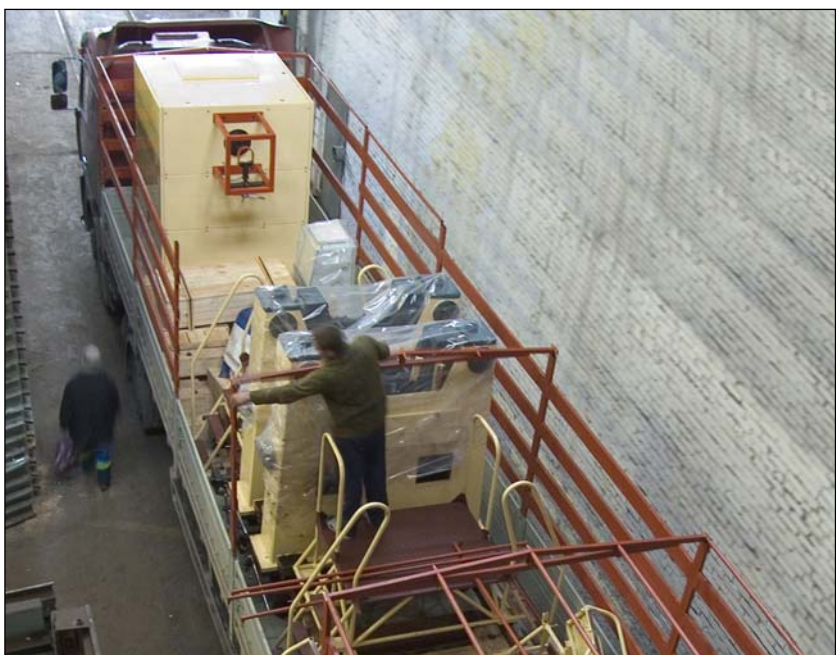
Рис. 3. Транспортировка балансировочного станка VM-36000 на специальном автоприцепе.
