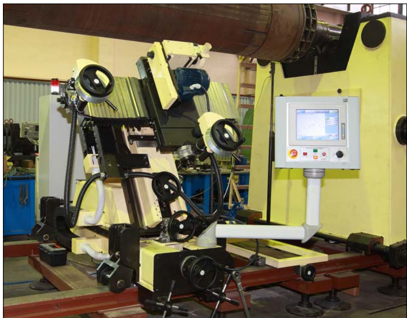
Рис. 4. Специальный комплекс ПТШ-40 с компьютерным управлением, смонтированный на основании балансировочного станка для токарной и шлифовальной обработки поверхностей роторов и контроля биений торцевых и радиальных поверхностей ротора.
