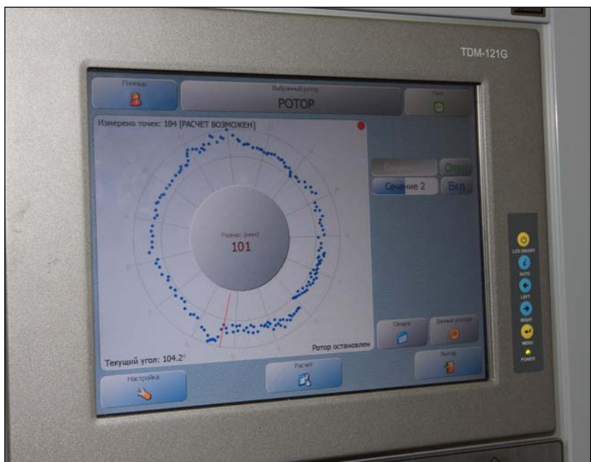
Рис. 5. Отображение процесса измерения радиального биения ротора на экране монитора.
