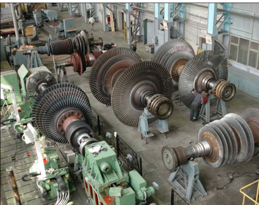
Рис. 1. Цех по ремонту роторов турбин специализированного ремонтного предприятия.
