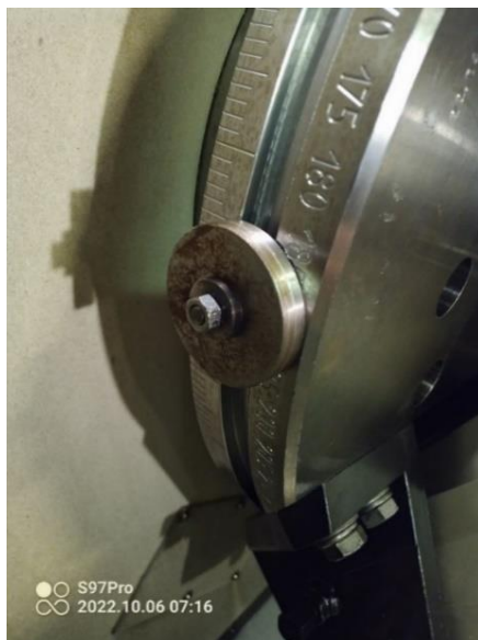
Рис. 4. Балансировочный груз, установленный на торце специального приспособления с градуированной шкалой
