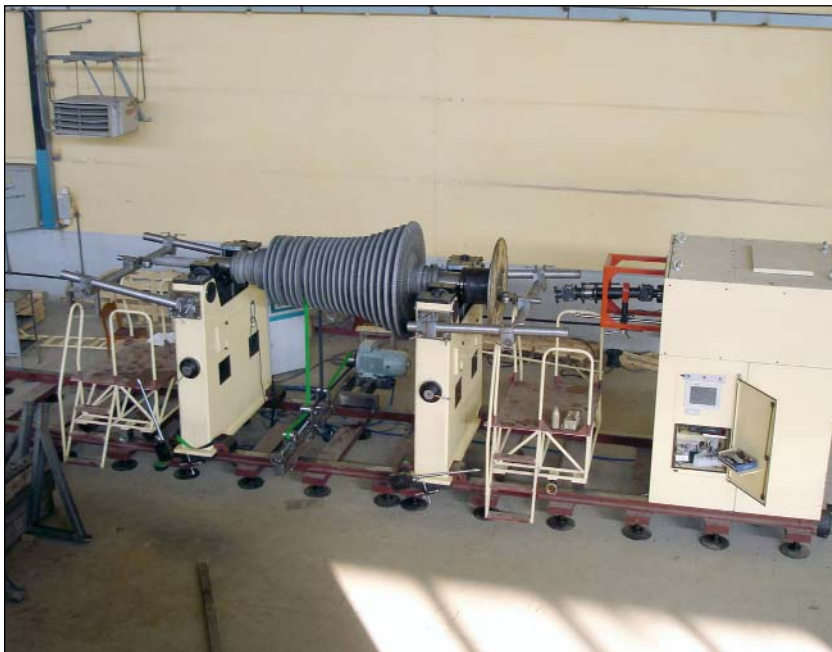
Транспортабельный балансировочный станок VM-36000, грузоподъемностью 40 тонн с ременным и карданным приводом
