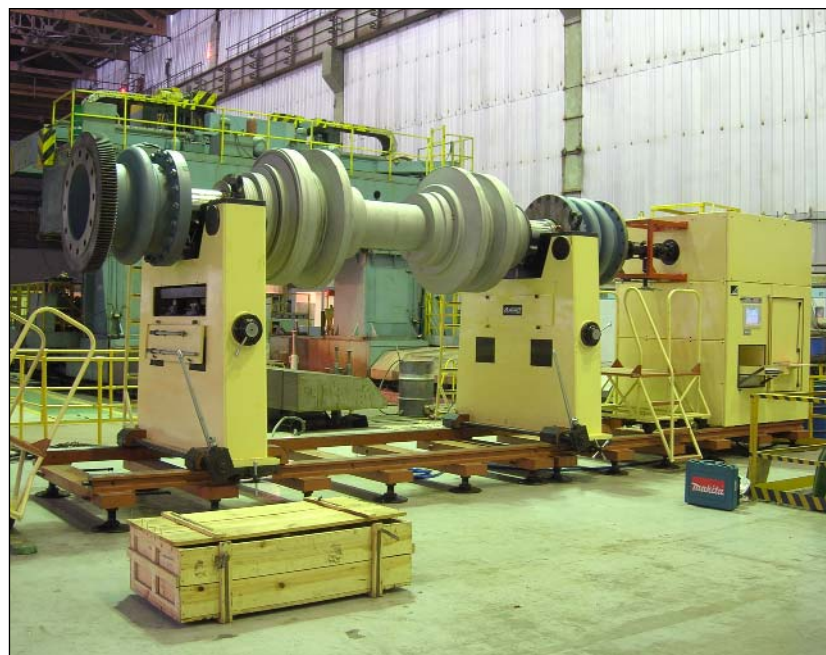
Балансировка ротора генератора массой 85 тонн на балансировочном станке VM-90000 (Сургутская ГРЭС-2)
