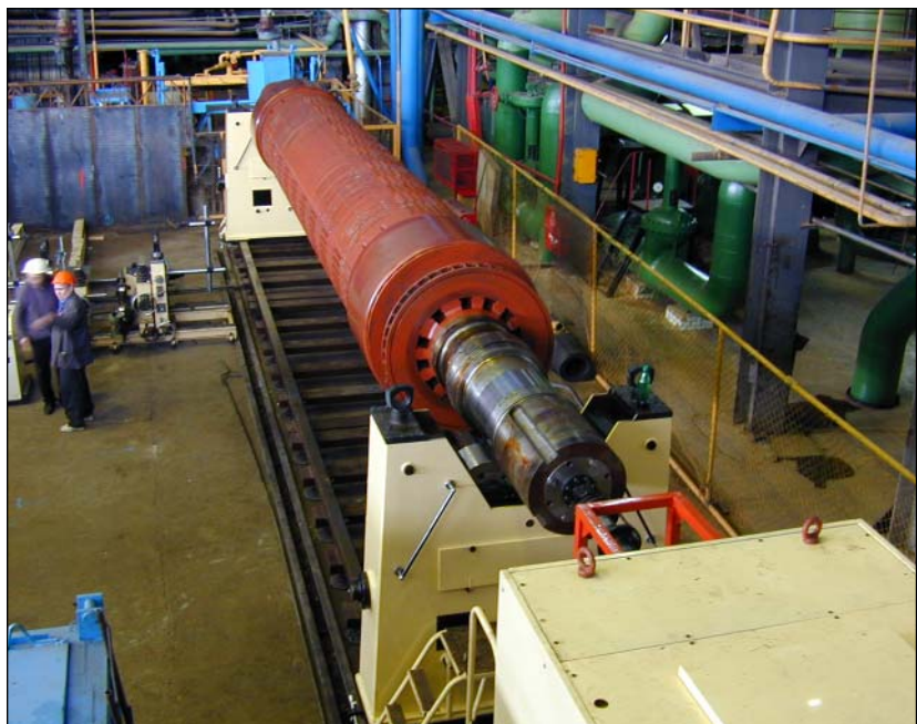
Балансировка ротора генератора массой 85 тонн на балансировочном станке VM-90000 (Сургутская ГРЭС-2)
